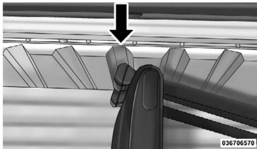
**Aligning Gate To Slots**
